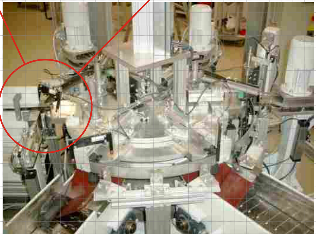
Station 6 Ausschleusung der n.i.O.-Teile
