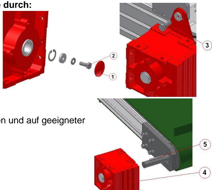
**Die Montage des Ersatz-Getriebemotors erfolgt in umgekehrter Reihenfolge.**
