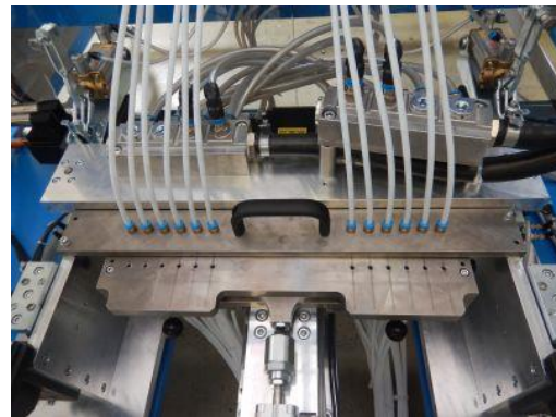
Verteilschieber & 48-fach Abblasvorrichtung
