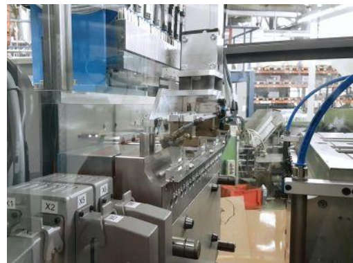
32-fache Bestückung des Werkzeugs der SGM
