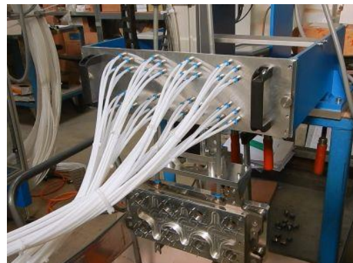
48-fache Bestückung des Werkzeugs der SGM
