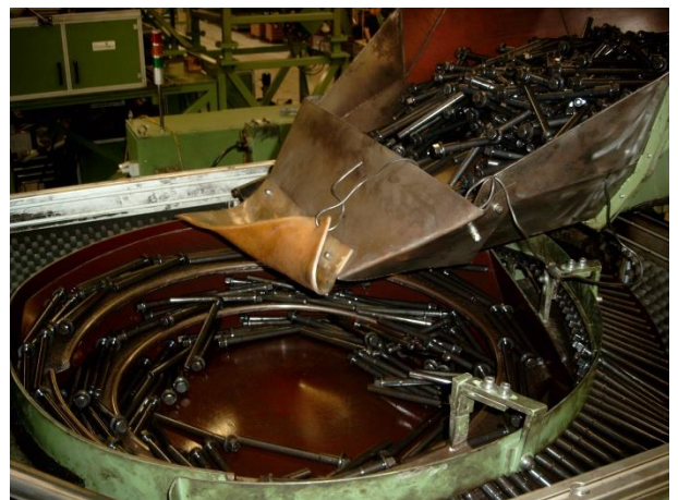
Sortieroberteil im Einsatz mit öligen Schraubenrohlingen
