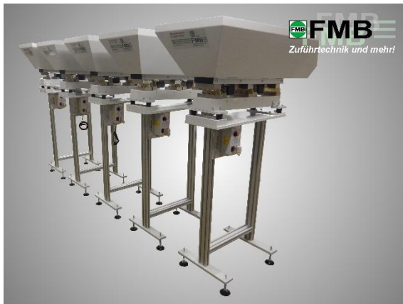
Beispielfoto zeigt BVB-100 mit Linearschwingantrieb Typ BSR-3
