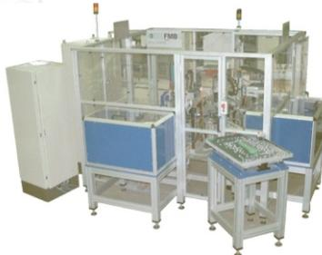
Vollautomatische Montageanlage für ein Gewindeschloss, bestehend aus drei Einzelteilen.
