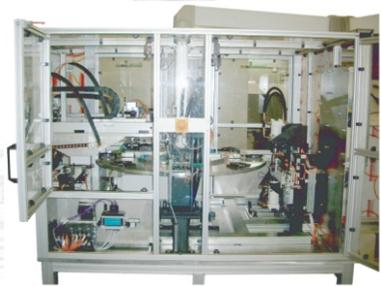
Vollautomatische Montageanlage für Getrieberäder, bestehend aus zwei Einzelteilen.
